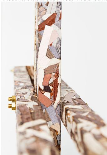
BÉTON DIT MARBRE RÉALISÉ À PARTIR DE GRAVATS DE CHANTIER
